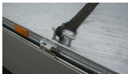
Zurrbügel ausziehbar, lieferbar bei Stahlboden
