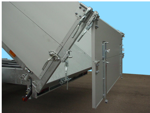
Winkelhebelverschlüsse (MP) statt integrierte Verschlüsse Pendelklappe hinten (Mehrpreis) abnehmbare Eckrungen serienmäßig
